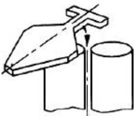
Рисунок Г.8 - Испытания прямоугольных зазоров с использованием зоны Б шаблона
