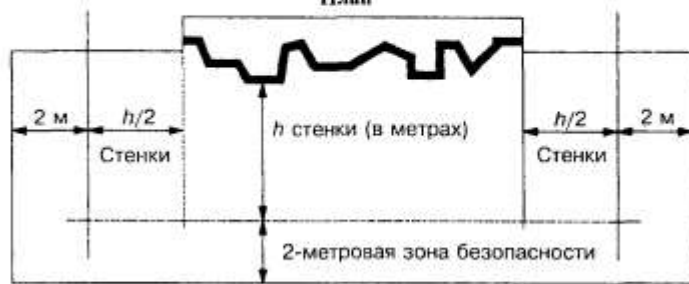
2. Размеры снепокрытия площадок у скальной стенки (зона безопасности) План
